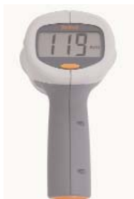
Hastighetspistol för hastighetsmätning.
